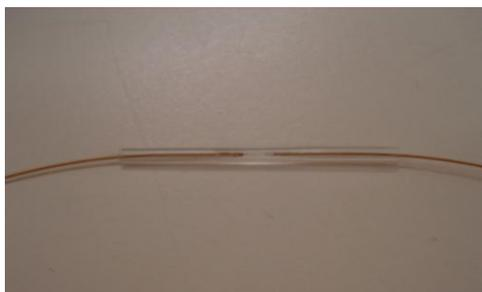
**Figura 11.** Fotos do conector empregado para fechar os capilares de sílica durante os tratamentos térmicos.
