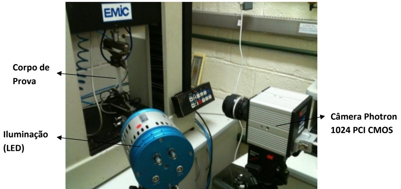
Figura 10: Montagem de equipamentos utilizada para ensaio de tração e captura das imagens
