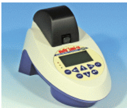
Figura 4.2 Ilustração do luminômetro BIOFIX® LUMI-10 utilizado nos testes com o V. fischeri . Fonte: www.hellotrade.com
