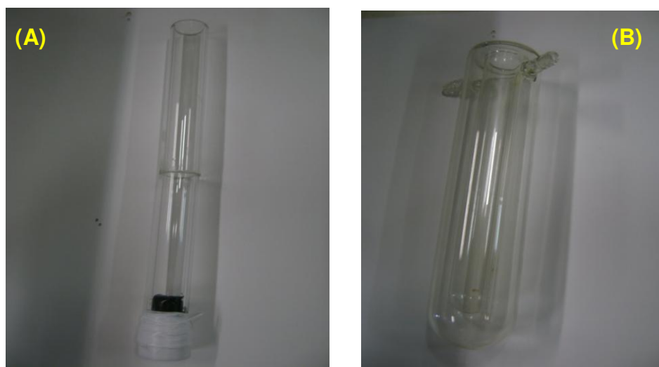
Figura 3.5 - Detalhes dos tubos de quartzo (A) de parede única e (B) de parede dupla utilizados nos ensaios com iluminação.
