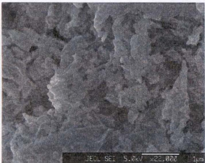
**Figura 33c-** Microscopia eletrônica de varredura da amostra 23, preparada a partir de silicato de tetrametilamônio, HF, CTABr/SiO<sub>2</sub> = 1,5, calcinada e liofilizada.
