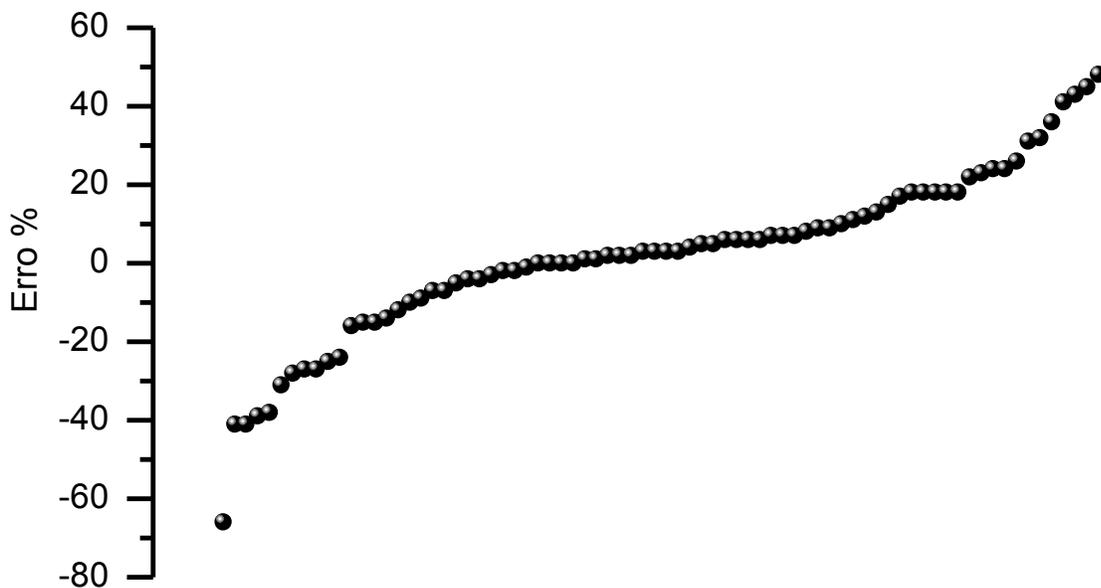
**Figura B.** Erros relativos para a previsão e validação para o modelo final do conjunto de dados (2) do em ordem crescente.
