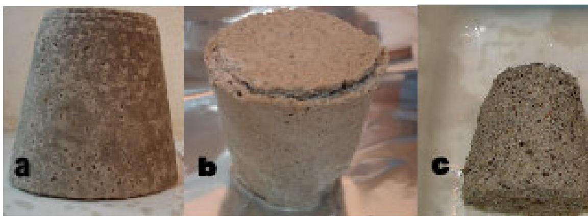
Figura 26 - Corpos de prova de argamassa de cimento composto tipo CP-III, curados por 28 dias, expostos a ácido sulfúrico 1,0 \text{ mol L}^{-1} . Antes da exposição (a), após 5 (b) e 10 semanas de exposição (c).
