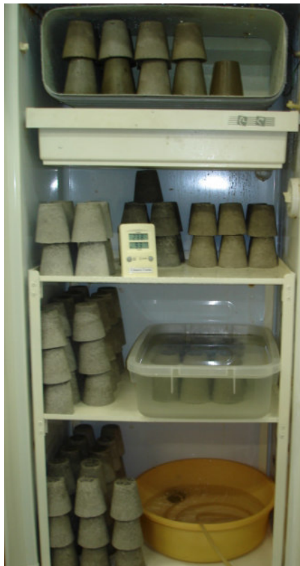
Figura 4- Câmara úmida para cura dos corpos de prova
