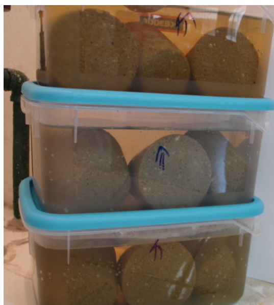
Figura 5 – Triplicata de amostras em ensaios de ataque ácido analisados via gravimetria.
