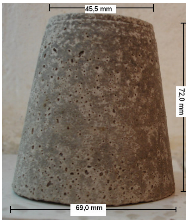
Figura 2 – Dimensões dos corpos de prova (cone truncado)
