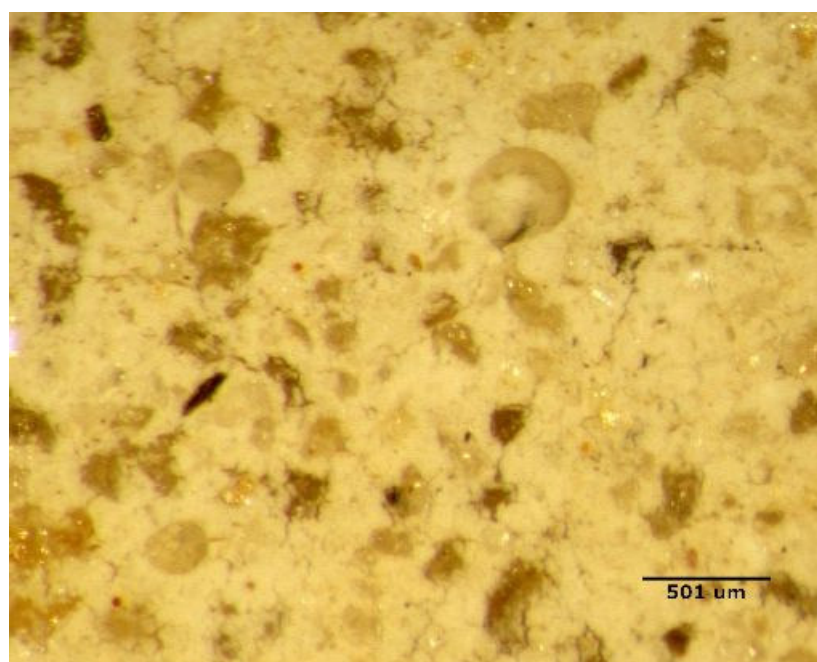
Figura 23 - Superfície de corpo de prova de argamassa de cimento CP-V ensaiado com \text{H}_2\text{SO}_4 em \text{pH}=2 .
