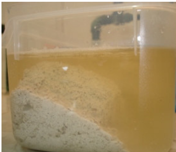
Figura 10 – Corpo de prova de argamassa degradado em ensaios de ataque ácido analisados via gravimetria
