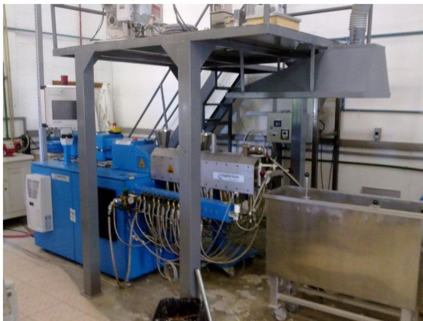
**Figura 3.1** – Extrusora duplas rosca Coperion ZSK-26.
