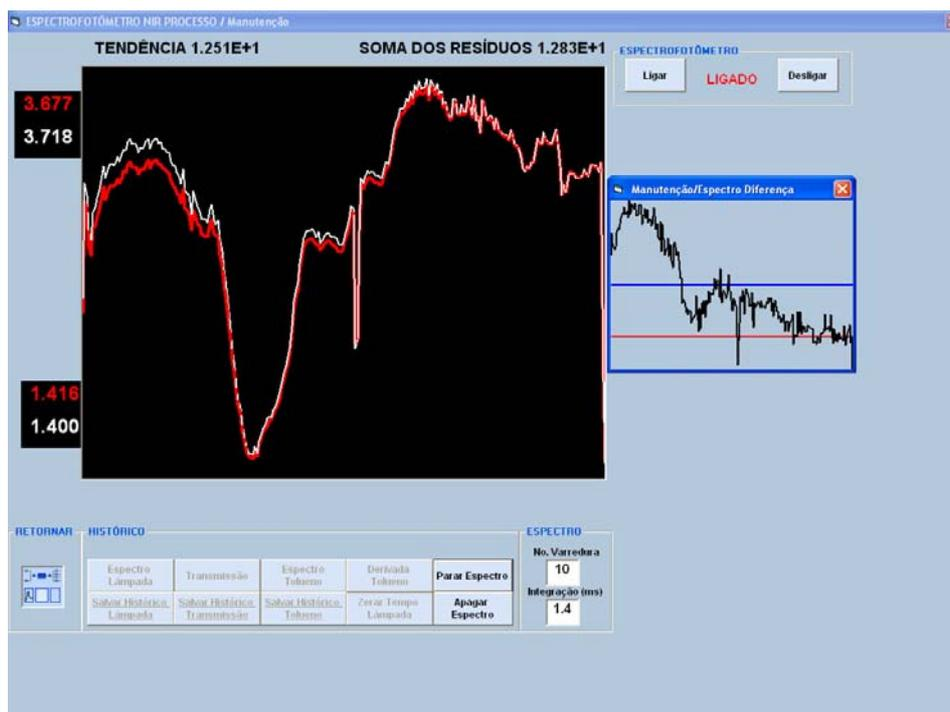
**Figura 156.** Espectros de transmitância de tolueno da lâmpada anterior (vermelho) e lâmpada nova (branco), com o melhor ajuste obtido.
