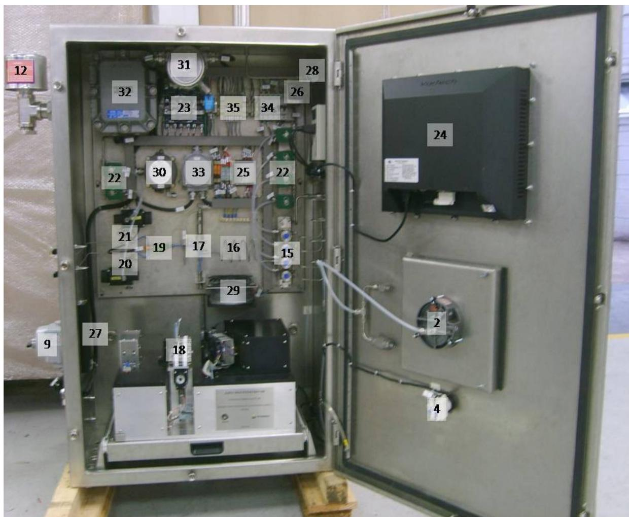
**Figura 59.** Gabinete do analisador (interior, com marcação das partes principais).
