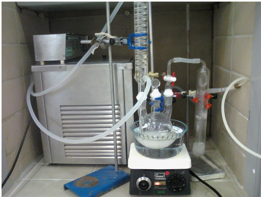
**Figura 10.** Sistema de refluxo para a reação de capeamento.
