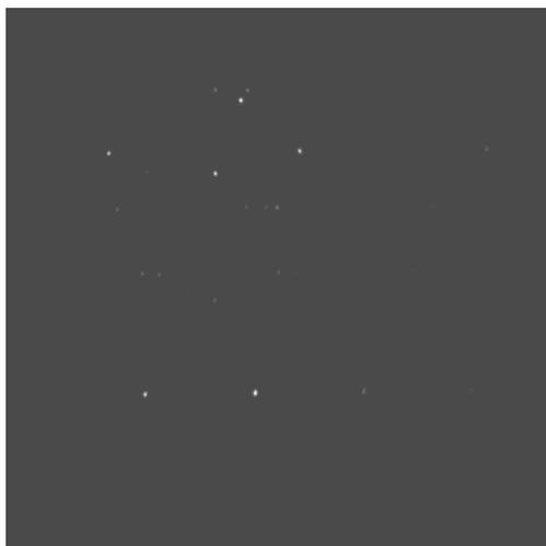
**Figura 4.** Echellograma de uma lâmpada de mercúrio/ argônio.
