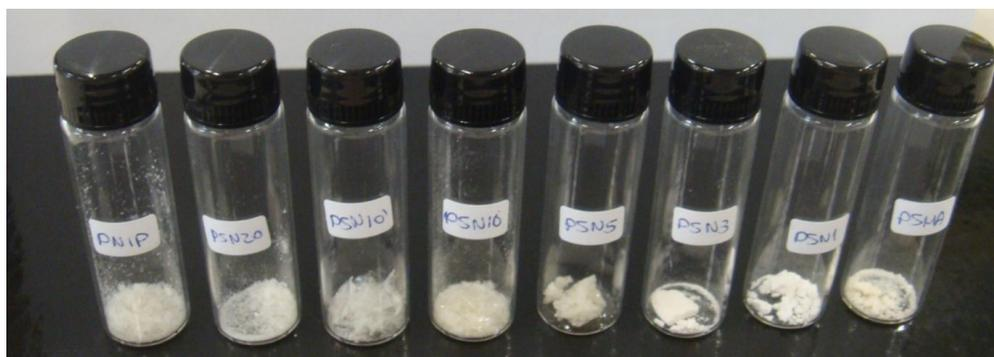
**Figura 4.8.** Copolímeros constituídos de SMA e NIPAAm, com aumento de fração molar de NIPAAm indo do PNIPAAm (esquerda) ao PSMA (direita).
