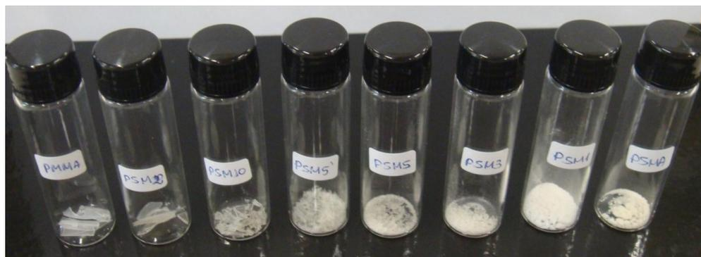
**Figura 4.7.** Copolímeros constituídos de SMA e MMA, com aumento de fração molar de MMA indo do PMMA (esquerda) ao PSMA (direita).
