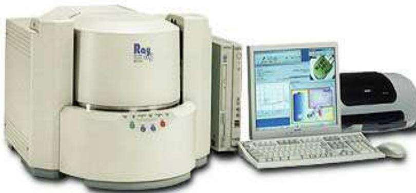
**Figura 8:** Espectrômetro de fluorescência de raios X por energia dispersiva (EDX-700).
