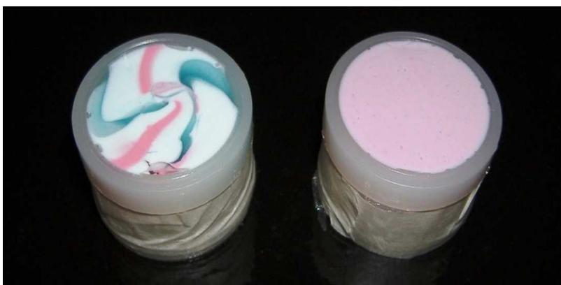
**Figura 10:** Celas de polietileno com filme Mylar<sup>®</sup> com cremes dentais antes e após a homogeneização.
