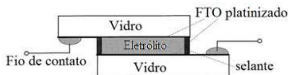
**Figura III.5** – Ilustração da célula eletroquímica utilizada nas medidas de voltametria cíclica do eletrólito polimérico gel.
