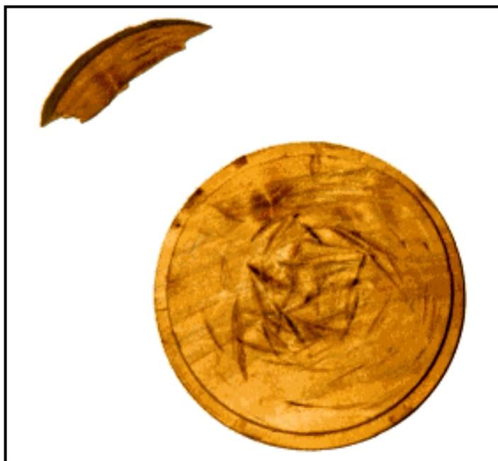
**Figura 20** : Resultado do Impacto da Onda de Choque na tampa de “Celeron” ao atingir a tampa do “Silencioso”.
