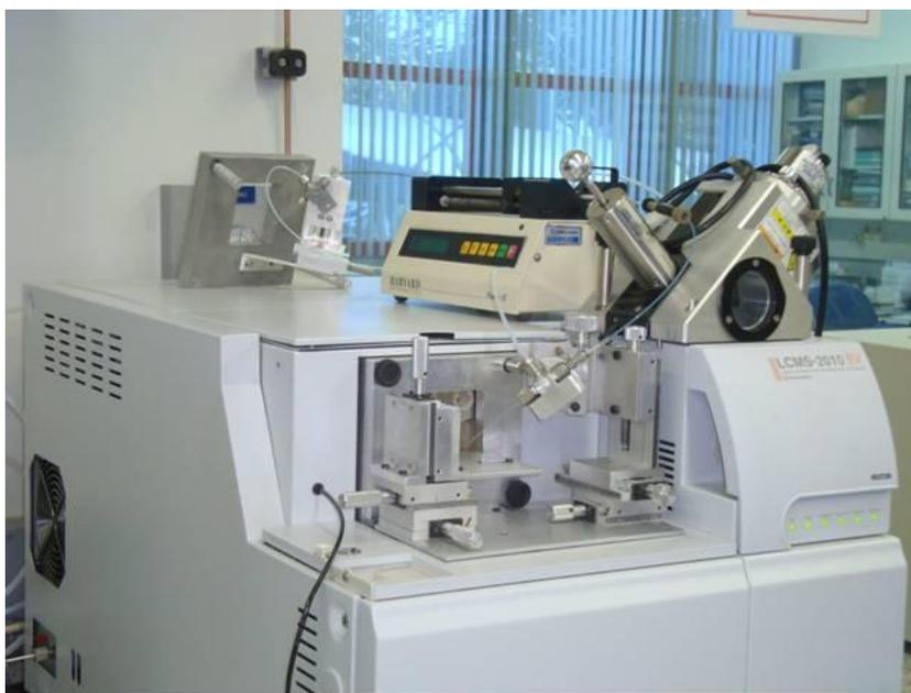
**Figura 11.** Equipamento monoquadrupolo com fonte de EASI MS utilizado para as análises de óleos vegetais.
