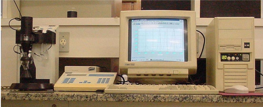
**Figura 4.** Analisador Polarográfico e o “Stand” Polarográfico utilizados nas medidas voltamétricas para a determinação de níquel.
