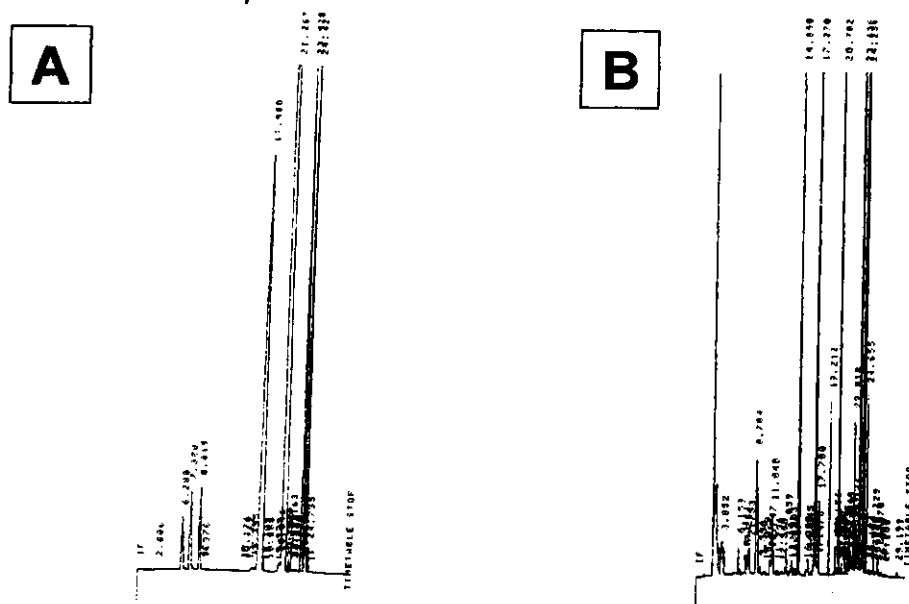
Figura 14 – Cromatogramas obtidos para extrações da mistura de teste com a fibra P100 (A) e CAR (B) com t_{\text{ext}} = 50 min. Fundos de escala diferentes para cada cromatograma.
