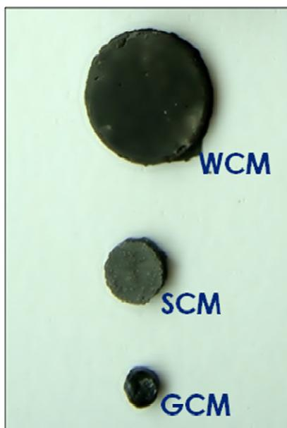
**Figura 6.** Discos cerâmicos obtidos a partir dos corpos verdes moldados sob prensagem.
