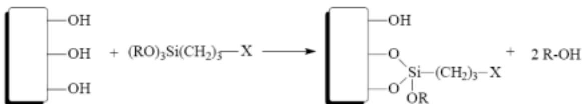
Figura 9. Condensação entre os grupos alcóxidos e silanóis da superfície da sílica.
