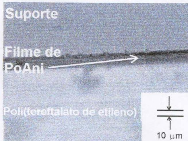
Figura 15: Micrografia óptica do filme de PoAni depositado por *spin-coating* (aumento de 600 X)
