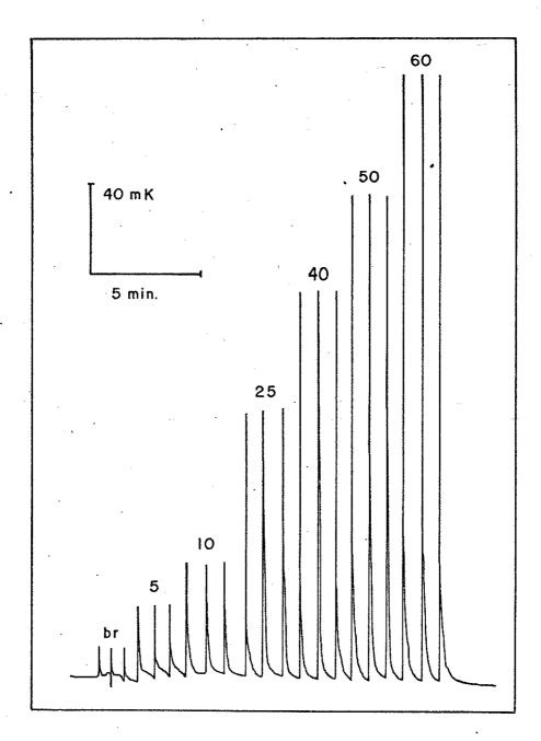
Figura 10 - Corrida da calibração para a reação de complexação dos ions de cálcio por Na<sub>2</sub>-EDTA usando-se a configuração em confluência. Os números locados acima dos sinais entalpimétricos, significam a concentração mM.
