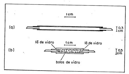
Figura 4 - Colunas de Reação. 4a, coluna de reação aberta.
