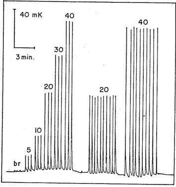
Figura 11 - Corrida analítica da reação de complexação do Mg-EDTA com os ions de cálcio na faixa de concentração de 5 a 40 mM e em seguida, a injeção sucessiva das soluções de 20 e 40 mM, respectivamente. Os números acima dos sinais entalpimétricos representam a concentração mM.
