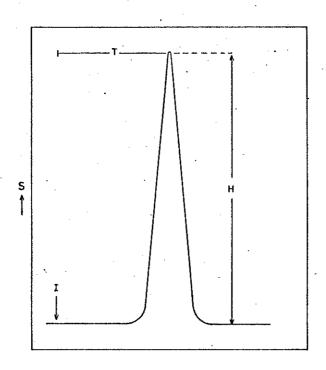
Figura 5 - Sinal entalpimétrico típico gerado. I, injeção da amos tra. T, tempo de residência. H, altura do pico que é relacionado à concentração da amostra.
