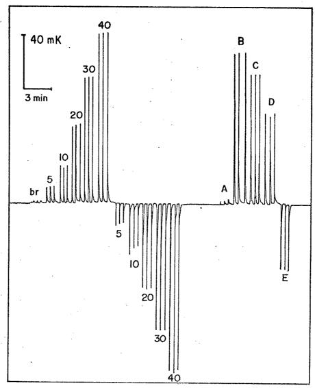
Figura 18 - Corrida analítica para o levantamento das curvas padrão de cálcio e magnésio e de amostras sintéticas de composições variadas representadas na tabela 7 através da reação de complexação com Na<sub>2</sub>-EDTA. Os números e letras locados nos sinais entalpimétricos representam a concentração mM e composição da amostras sintéticas (tab.7)
