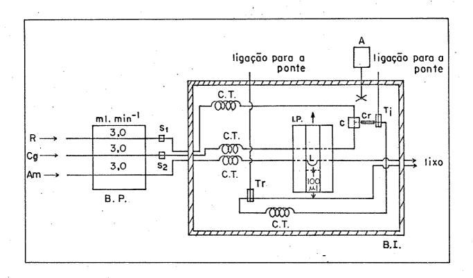
Figura 1 - Diagrama do Entalpimetro de Fluxo Continuo.
