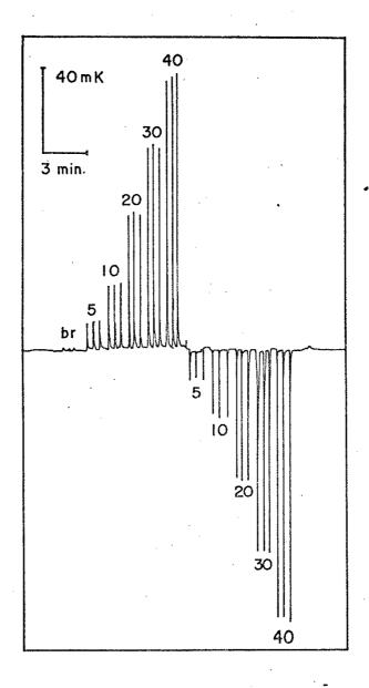
Figura 17 - Corrida de calibração para o levantamento das curvas padrão de cálcio e magnésio respectivamente, através da reação de complexação com Na<sub>2</sub>-EDTA. Os números referentes a cada sinal entalpimétrico significam a concentração mM.
