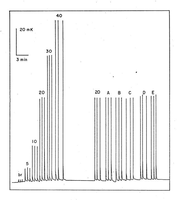
Figura 13 - Corrida de calibração para a reação de complexação dos fons de cálcio com Mg-EDTA, seguida de amostras sintéticas. Os números e as letras acima dos sinais entalpimétricos significam a concentração mM e as amostras sintéticas conforme a tabela 4, respectivamente.
