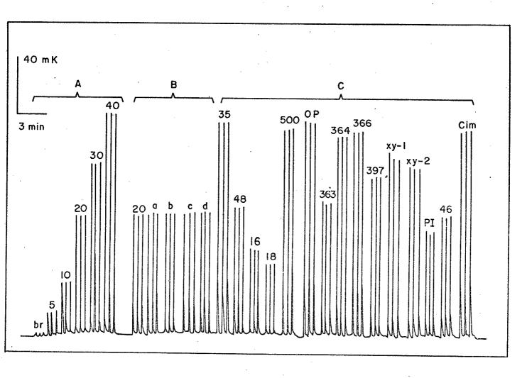
Figura 15 - Corrida de calibração para a curva padrão, amostras sintéticas, amostras certificadas e em estudo.
