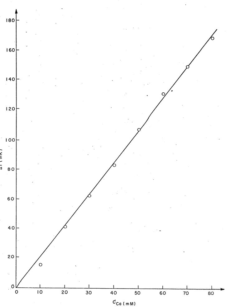
Figura 7 - Curva padrão para a determinação da concentração de fons de cálcio por meio da precipitação com oxalato de amônio.
