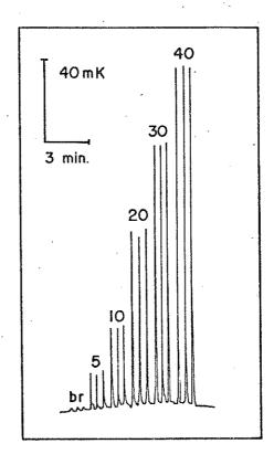
Figura 14 - Corrida de calibração para o levantamento da curva padrão de cálcio através da reação de complexação com Mg-EDTA. Os números acima dos sinais entalpimé tricos representam a concentração mM.
