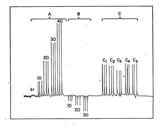
Figura 8 - Corrida de calibração na reação de precipitação dos fons de cálcio com oxalato de amônio e o efeito dos interferentes.
