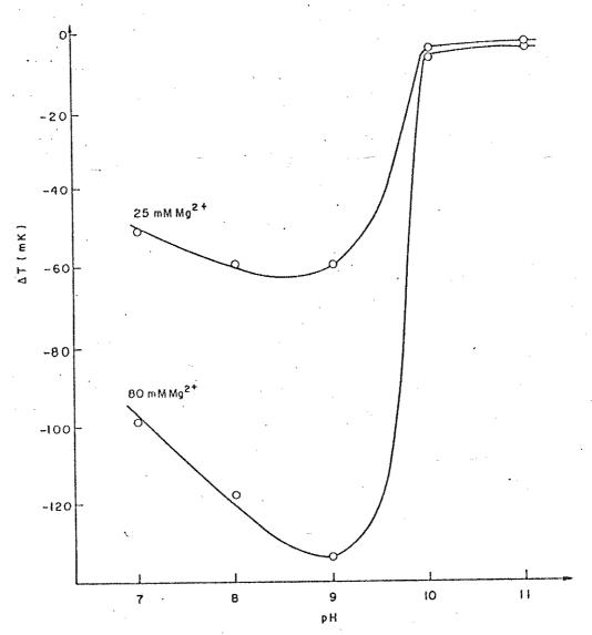
Figura 16 - Efeito da acidez na magnitude do sinal entalpimétrico, usando-se duas séries de soluções padrão de magnésio de 25 e 80 mM em reação de complexação com solução de Na<sub>2</sub>-EDTA 0,20 M.
