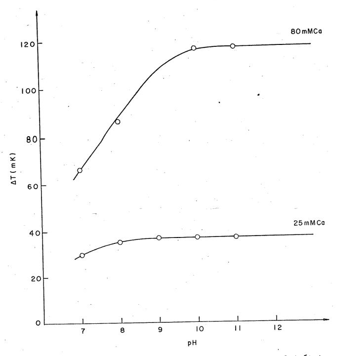
Figura 9 - Efeito da acidez na magnitude do sinal entalpimétrico, usando-se duas séries de soluções padrão de cálcio de 25 e 80 mM em reações com solução de Na<sub>2</sub>-EDTA 0,20 M.
