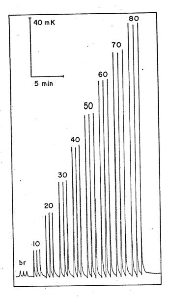
Figura 6 - Corrida de calibração para a reação de precipitação dos fons de cálcio por oxalato de amônio usando-se uma configuração em confluência. Os números acima dos sinais entalpimétricos significam a concentração de cálcio (mM).
