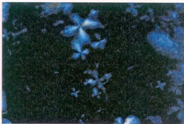
Figura 4.39. Textura característica de uma mesofase lamelar (esferulites) + isotrópica (parte preta), aumento 100X. Espessura:0,5mm. Temperatura: 50°C, amostra S235, com TTAB (44,755%), n-DeOH (7,21%), H 2 O (48,04%).
