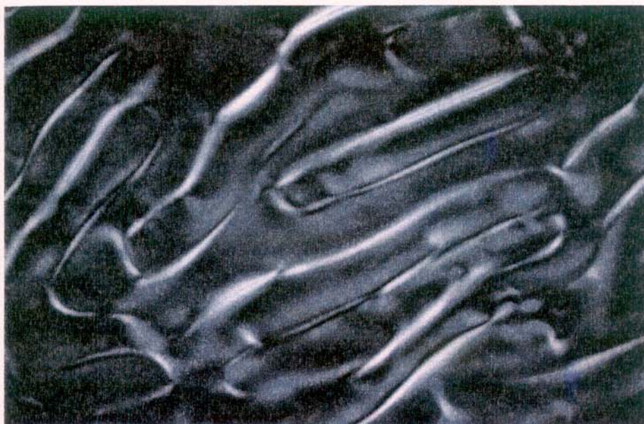
Figura 4.13. Textura observada em um domínio planar, característica de uma mesofase nemática calamítica, depois de uma aplicação de um campo magnético de 1,4 Tesla normal à superfície da placa, por 12 horas. Amostra S770, com TTAB (40,11%), NaBr (2,33%), H 2 O (57,56%). Aumento 100X. Espessura: 0,5mm. Temperatura: 22°C.
