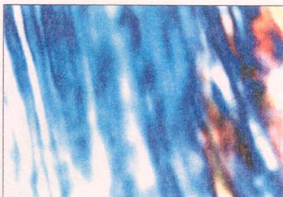
Figura 4.40. Textura característica de uma mesofase nemática calamítica. Conhecida como textura de Schlieren (textura nemática calamítica de Schlieren). Amostra S225, com TTAB (33,58%), n-DeOH (1,85%), H 2 O (64,57%). Aumento: 100X. Espessura: 0,5mm. Temperatura: 22 °C.
