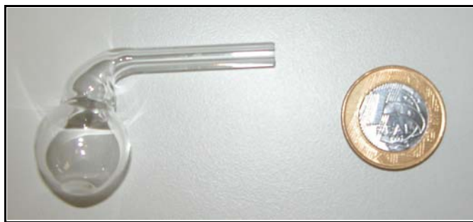
Figura 16 – Ampola ou retorta utilizada para inserir líquidos no pentaquadrupolo.
