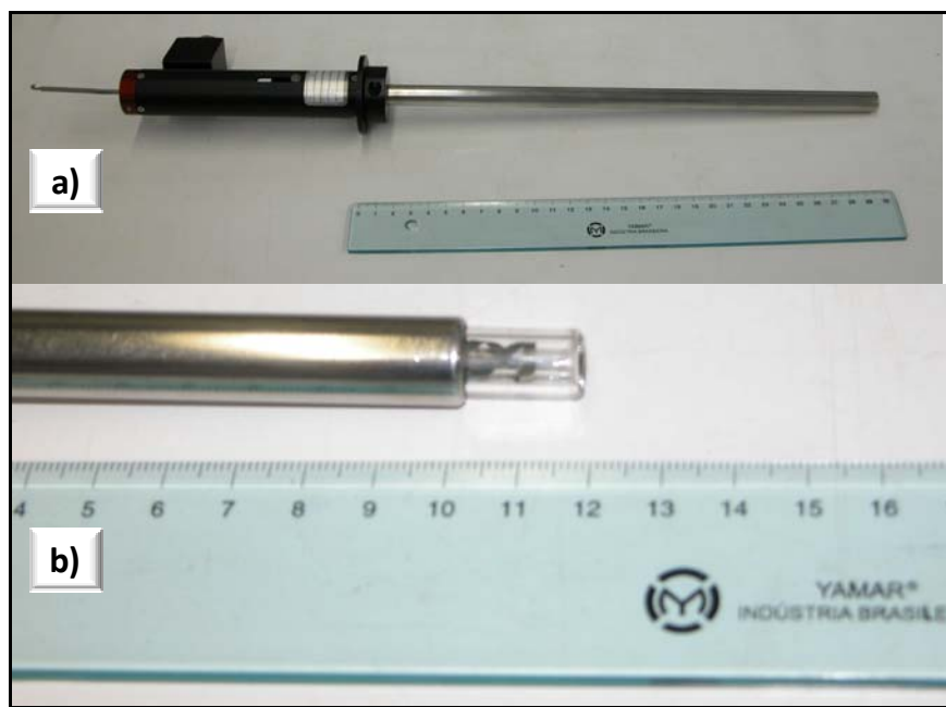
Figura 19 – Sonda para inserção de sólidos na fonte de ionização (a) e a parte retrátil da sonda, dentro da qual é alojado o cadinho com o sólido desejado (b).
