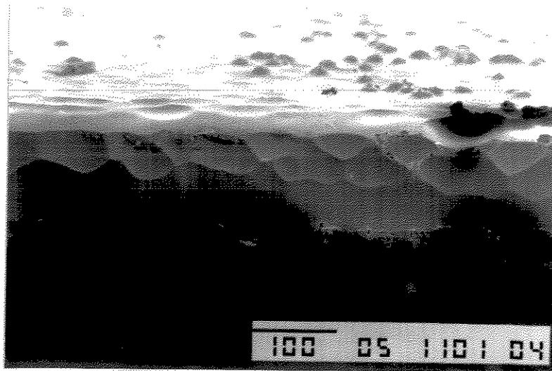
Figura 29. Micrografia eletrônica de varredura de fratura de filme de PEBD submetido a erosão com ácido permangânico (procedimento de Naylor e Phillips [83]), por 30 min.
