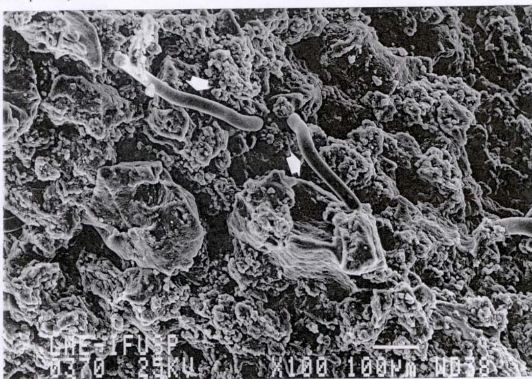
Figura 44 – Micrografia obtida por microscopia eletrônica de varredura da borracha de pneu triturado, borracha B, moldada a 200 °C, por 3 horas e força de 10 Kgf onde as setas mostram presença de fios.
