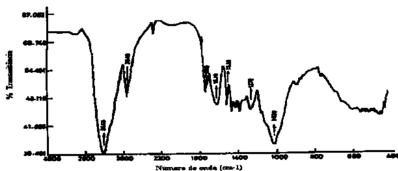
Figura 9 – Espectro na região do infravermelho (FTIR) para a fibra de coco [103]. Pastilha de KBr.
