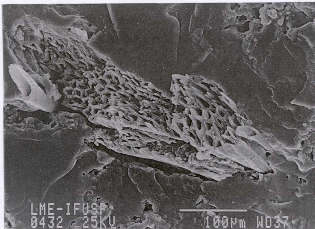
Figura 58 – Micrografia obtida por MEV da superfície de fratura do compósito de borracha A / fibras de sisal sem tratamento. Fratura em nitrogênio líquido.
