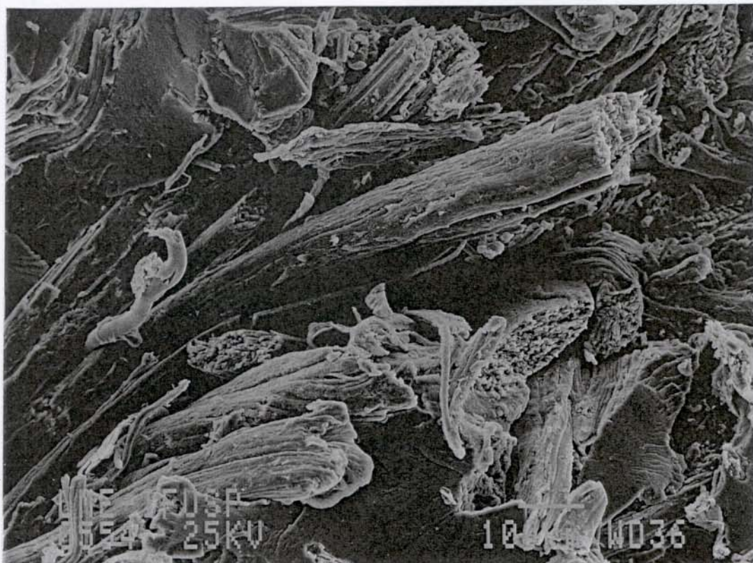
Figura 66 – Micrografia obtida por MEV da superfície de fratura do composto de borracha de pneu triturado com 30% de fibras de sisal mercerizadas e acetilada. Fratura em nitrogênio líquido.
