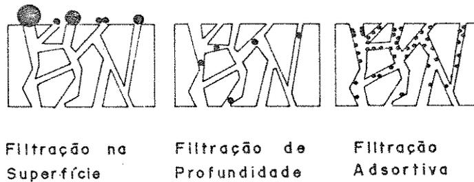
Figura 4- Mecanismos de Filtração <sup>(34)</sup>.
