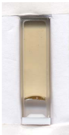
Figura 6 - Exemplo de imagem obtida utilizando montagem construída com scanner, suporte e cubeta
