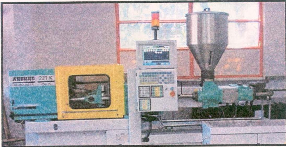
Figura III.4: Vista geral da injetora Arburg utilizada para preparação dos corpos de prova para tração e impacto.
