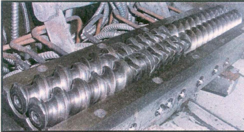
Figura III.3: Perfil das roscas utilizadas na preparação das blendas em extrusora de dupla rosca.
