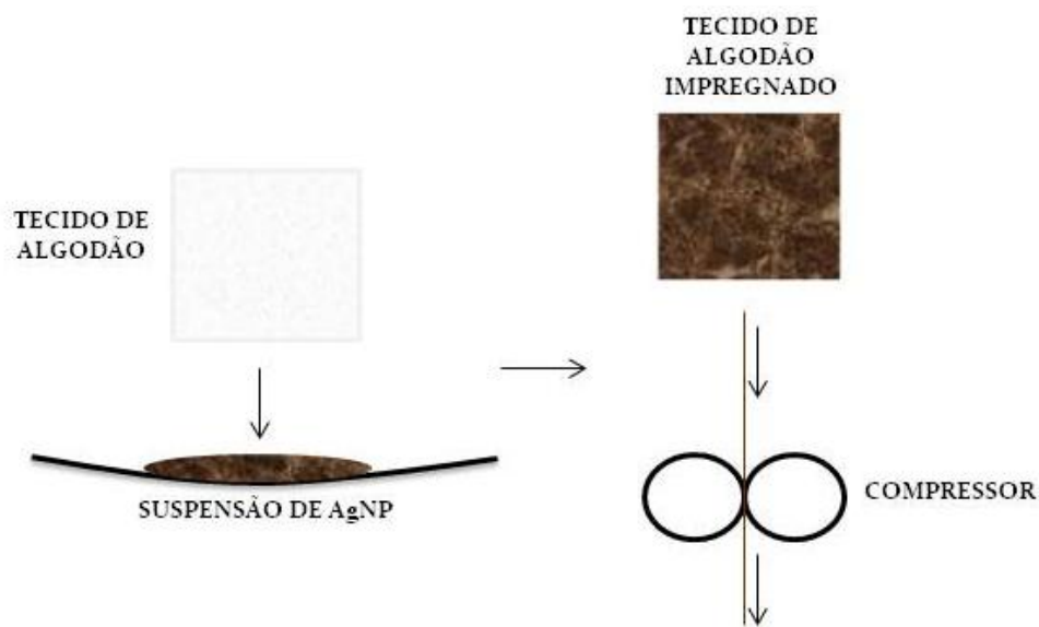
Figura 42. Representação esquemática da impregnação de AgNPs em tecido de algodão pelo método padding .
