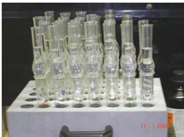
FIGURA 08 – Digestão em bloco digestor e refluxo com “dedo frio”
