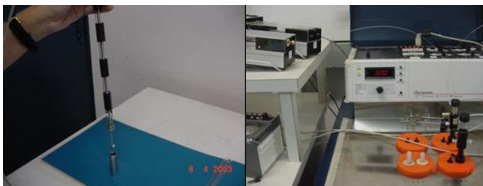
Figura 18. Fotos do sistema calorimétrico utilizado para determinar os efeitos térmicos do metal com as matrizes.
