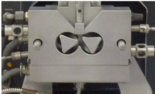
**Figura 4: Misturador Interno utilizado no preparo das blendas.**
