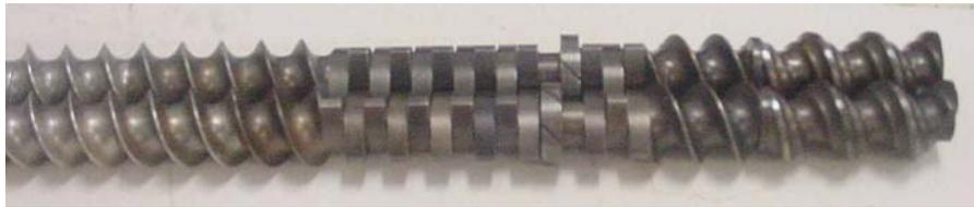
**Figura 5: rosca utilizada no processamento.**
