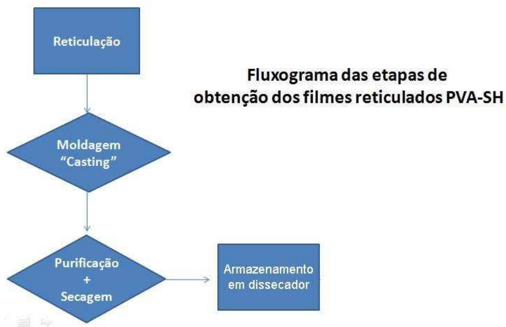
Figura 10. Fluxograma representativo das etapas de obtenção do material reticulado.
