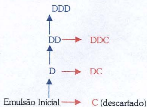
Figura 3.1.1- Representação esquemática das amostras obtidas durante o processo de fracionamento (cremes em vermelho e fases diluídas em azul).
