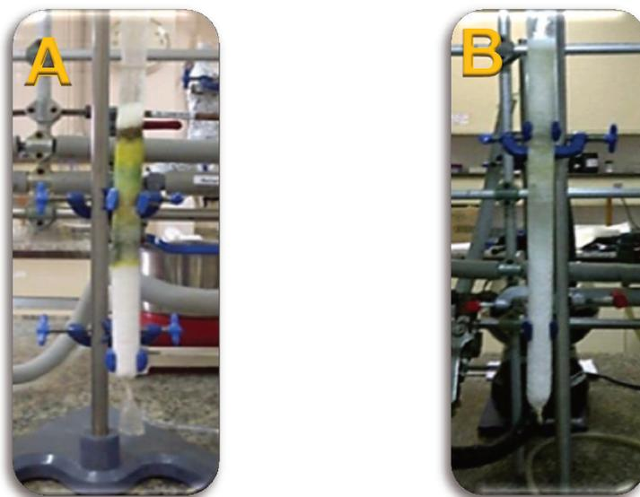
**Figura 15.** Esquema do fracionamento por Cromatografia em Coluna seca. (A) *Cromatografia em coluna seca do EC* e (B) *Cromatografia em coluna seca do OEX1*.
