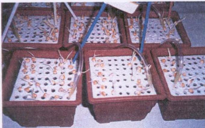
Figura 1: Sistema utilizado para tratamento das plantas em soluções nutrientes contendo 0 (controle), 6, 12, 36 e 60  $\mu\text{M}$  de  $\text{Al}^{3+}$ , em pH 4,1. As soluções eram aeradas e agitadas através de ar comprimido. Este passava previamente por uma solução concentrada de NaOH para diminuição da quantidade de  $\text{CO}_2$  do ar, evitando o abaixamento do pH da solução durante tratamento.
