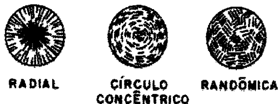
Figura - 1.3 - Modelos de estruturas transversais de fibras de matérias tipo PAN e piche 1 .
