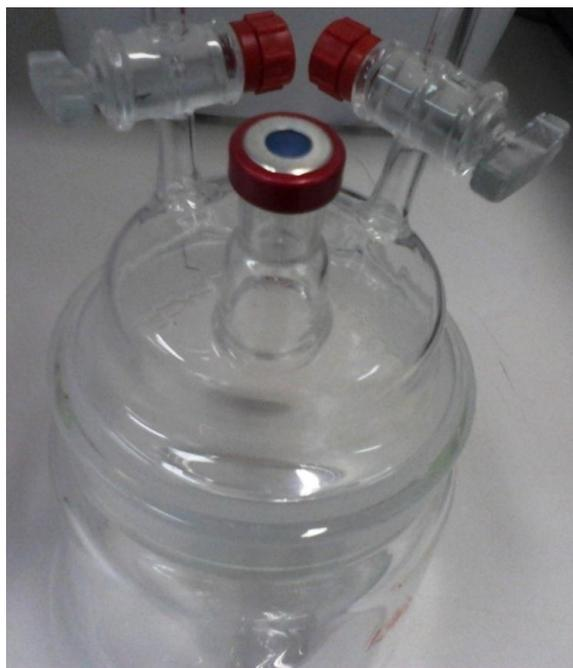
**Figura 6.** Jarro de vidro utilizado para a análise da barra inteira.
