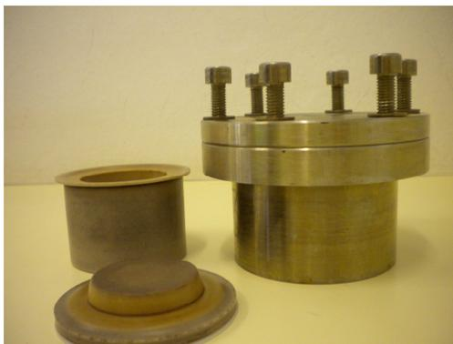
**Figura 1.2:** Imagens de uma autoclave de aço e seu respectivo recipiente interno feito de Teflon, onde acontecem as reações em ambiente fechado com pressões e temperaturas controladas.
