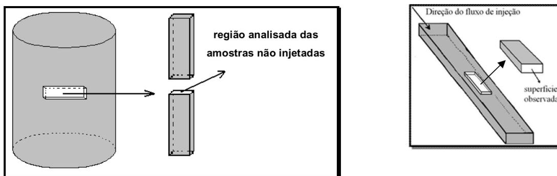
**Figura 3.10:** (a) Seção observada para blendas PMMA-AES não injetadas (b) Seção transversal analisada para blendas PMMA-AES injetadas.
