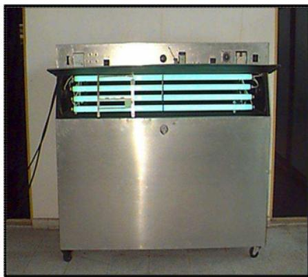
**Figura 3.11:** Câmara de envelhecimento fotoquímico [87].
