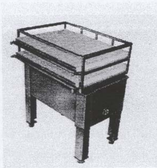
Figura-4: mesa agitadora Marconi, com movimento circular-horizontal, rotação mínima de 220 rpm e capacidade para 240 frascos cilíndricos.
