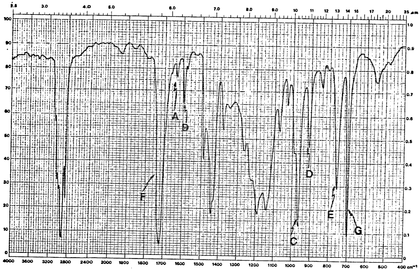
Figura 2.4.- Espectro IV para o MBS obtido a partir da enxertia dos monômeros MMA e St em sementes de SBR.
