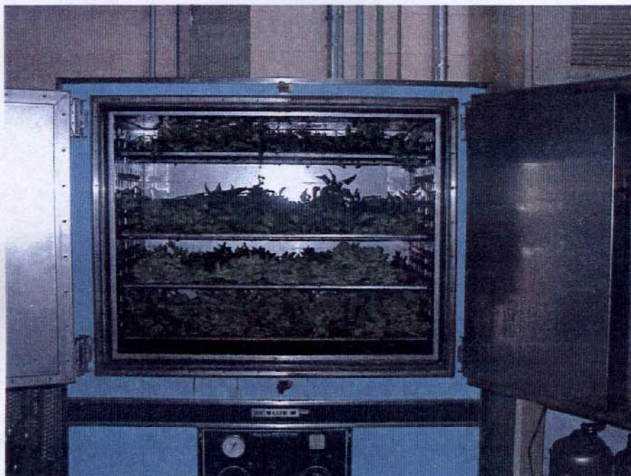
Figura III.6 Estufa de circulação forçada utilizada para secagem das plantas.
