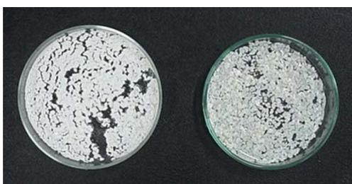
**Figura 32** – Filmes de PVA/TiO<sub>2</sub> dissolvendo-se em solução aquosa de AS.
