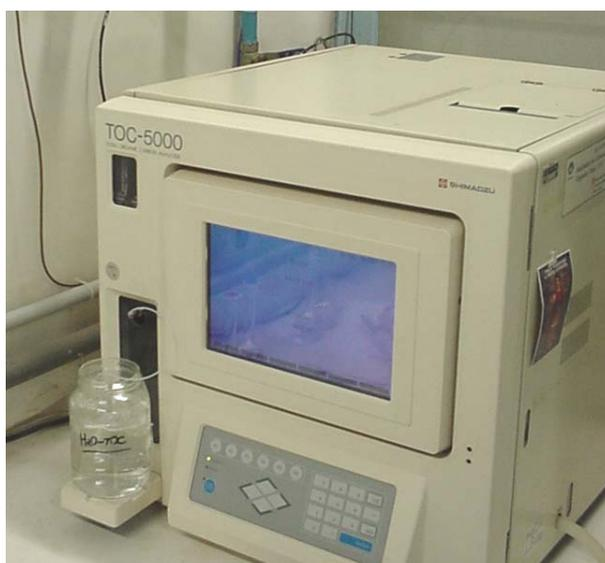
**Figura 9** – Analisador de Carbono Orgânico Total – TOC-5000 (Shimadzu).
