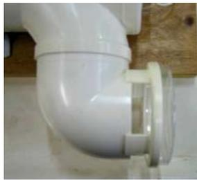
**Figura 20** – Suporte para placa de Petri conectado a saída de ar do reator.
