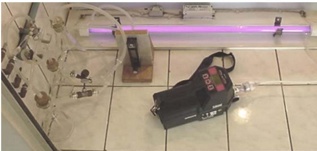
**Figura 11** – Experimento de fotólise de etanol em fase gasosa.
