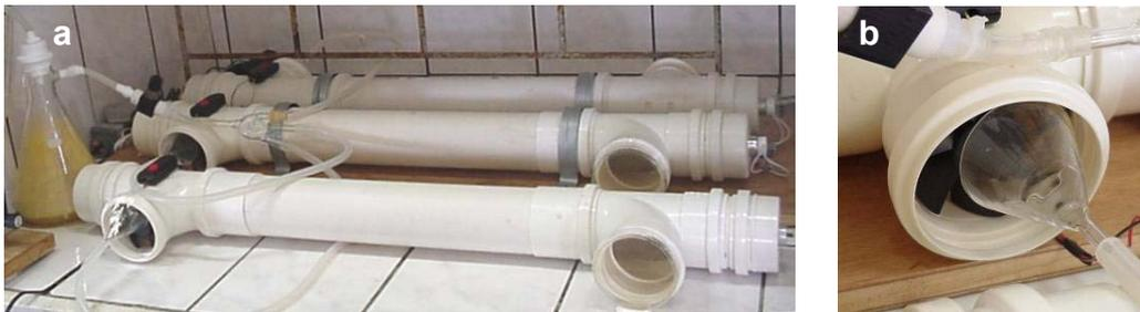
**Figura 19** – (a) reatores de PVC (controle, fotólise, FH) alimentados por ar contaminado; (b) mostrando em detalhes a entrada do ar contaminado para o reator.
