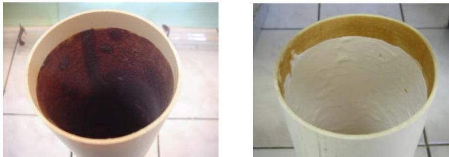
**Figura 15** – Filmes de Poliéster/TiO<sub>2</sub> depositados no interior do reator de PVC.
