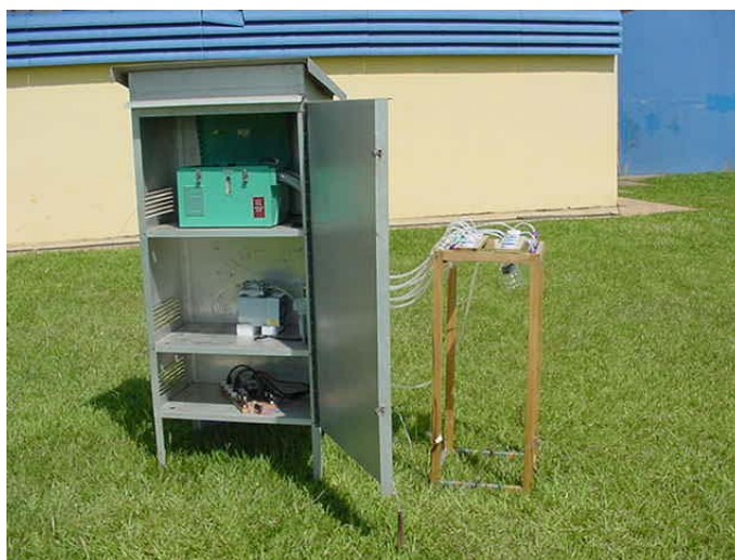
Figura 7: Foto do dispositivo para amostragem de MGT e mercúrio particulado.
