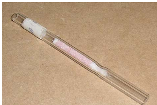
Figura 2: Coluna utilizada para amostragem de MGT.
