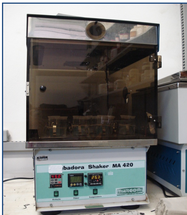
Figura 15: Incubadora Shaker MA 420, utilizada nos experimentos de sorção.
