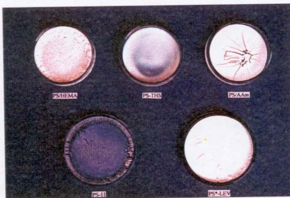
Figura 3.8 – Fotografia dos sólidos obtidos por secagem de látex recém preparado. As placas de Petri tem diâmetro de 50 mm. As amostras estão identificadas por legendas abaixo das placas de Petri. A fotografia apresenta o sólido de um látex que não foi analisado nesse trabalho (PS-11).
