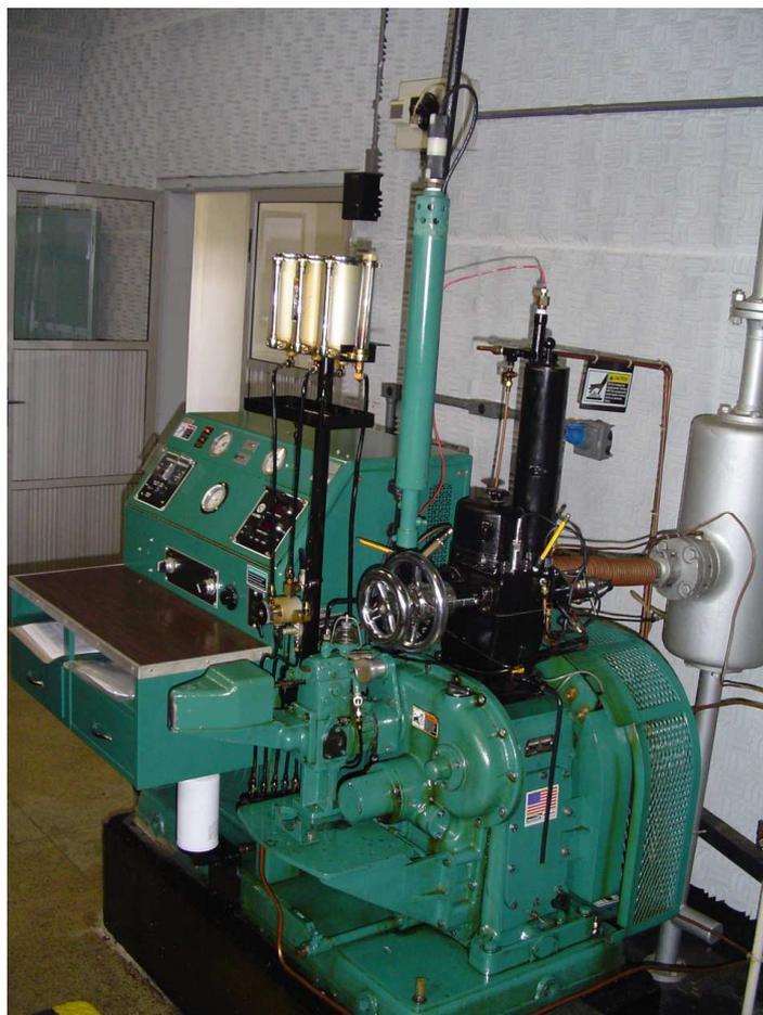
Fig. 3 – Motor para determinação de Número de Cetano
