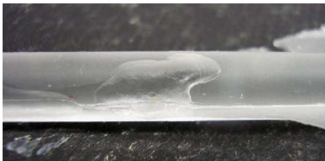
Figura 4.14: Defeito de injeção de um tarugo preparado no Mini Max Molder
