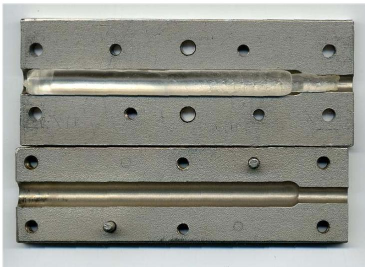
Figura 3.2: Molde bipartido aberto utilizado para moldagem por transferência de tarugos.
