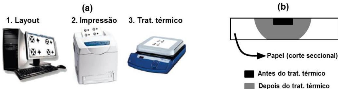
**Figura I.5.** (a) Etapas envolvidas no processo de construção. (b) Desenho estudado. (b) Esquema ilustrativo que mostra o espalhamento da cera pelo papel após o tratamento térmico. Figura adaptada [21]. Copyright (2009) American Chemical Society.
